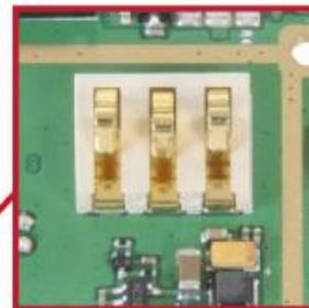
Três contatos de bateria, recobertos para uma melhor contato.
